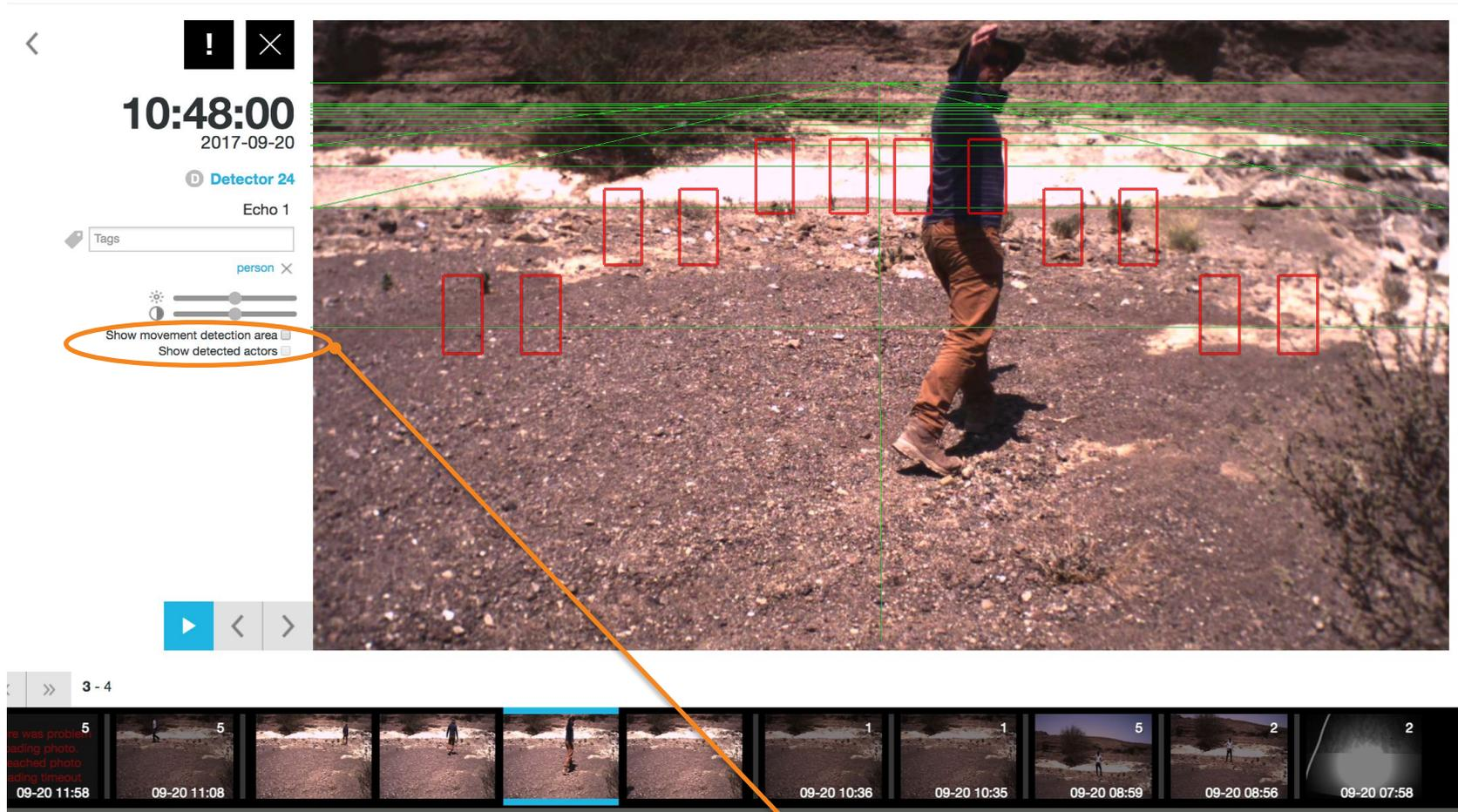
Les zones de détection de mouvement où le Détecteur déclenche des alarmes peuvent être activées en cochant cette case. La disposition exacte de la zone de détection dépend du PIR et du type de lentille PIR utilisé dans le Détecteur.
